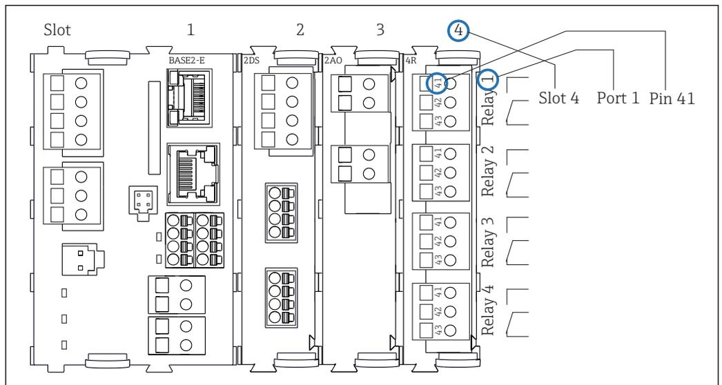
图 5 继电器常开触点 (41 号接线端子) 的接线端子分配图
