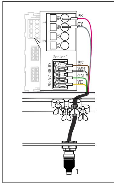
图 27 M12 接头 (例如在传感器模块上)
